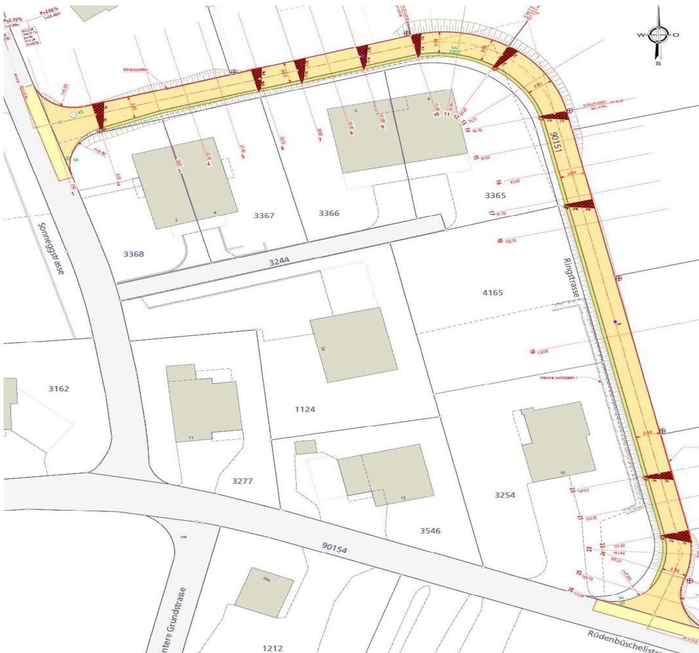
Bei der Ringstrasse sollen die Fundamentalschicht und der Belag komplett neu erstellt werden. Die Fundamentalschicht wird mit dem Kiesgemisch 0/45 erstellt mit einer Stärke von 40 cm. Darauf kommen die Trag- und Deck-
